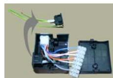
Motorkablets ledninger forbides til samledåsens klembræt. De forbides efter farver og numre. Overskydende ledninger kan klippes af. Overskydende ledninger kan fjernes eller tilsluttes på klemkassen, hvor der ikke er andre ledninger
