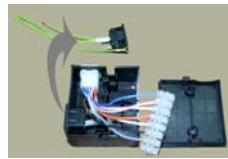
Motorkabelns sladdar förbinds till kabelboxens kopplingspanel.
