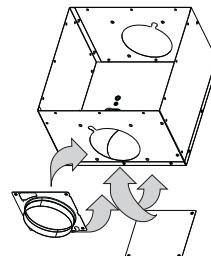
Om fläktkåpan inte är utrustad med Easy Cube borras et hål i närheten av fläktkåpans baksida där kabelboxen fästes. Se till att kabelboxen är lätt tillgänglig i tillfälle av eventuella reparationer och underhåll. Kabelboxen fästes på fläktkåpans utsida.
