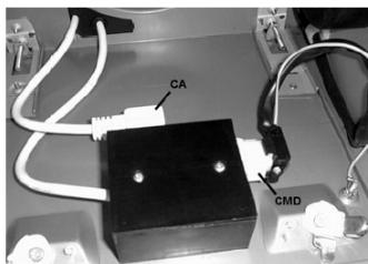
Podłączyć złącze zasilania **Ca** i złącze przycisków i oświetlenia **CMD** do pudełka instalacji elektrycznej.
