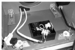
Umieścić kostkę w odpowiednim miejscu w środku pudełka instalacji elektrycznej, a w odpowiednie otwory na brzegach pudełka ułożyć przewody. Zamknąć pudełko a następnie dokręcić pokrywę.
