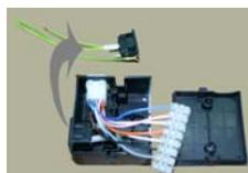
Соедините с клеммником коробки электрооборудования провода соединительного кабеля с вытяжкой, соблюдая соответствие цвета и номера проводов. Лишние провода можно удалить или соединить их с клеммной коробкой, свободной от других проводов.
