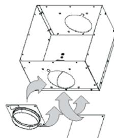
Pochłaniacz musi być podłączony z zewnętrznego wyjścia powietrza do okapu za pomocą rury o średnicy 150mm.
