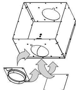
Вытяжное устройство должно быть соединено с вытяжкой и с выпускным отверстием воздуха наружу трубками Ø 150.
