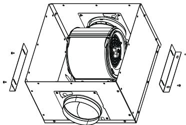
1. Afhængig af placeringen på luftudledningspanelet, fjernes skruerne. Som vist på illustrationen.
