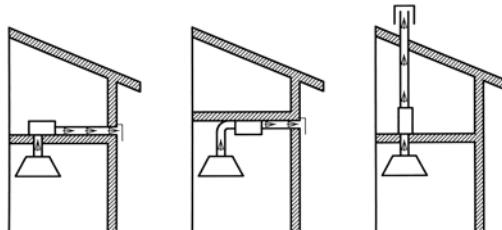
Afhængig af den valgte placering kan det være nødvendigt at skifte position på luftindtagningspanelet og flangen med dækpladen.
