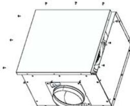
Umieścić pokrywę obudowy dopasowując otwory, a następnie dokręcić wykorzystując śruby na wyposażeniu.
