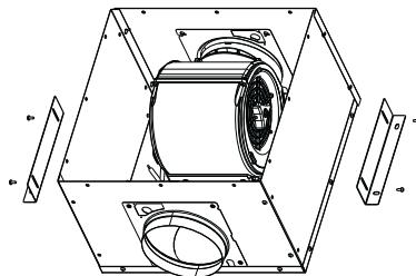
1. Beroende på luftutloppspanelens placering lossas skruvarna som på illustrationen.
