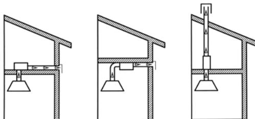
Beroende på placering av luftutlopp kan det bli nödvändigt att byta luftintagningspanelens och flänsens position med täckplåten.
