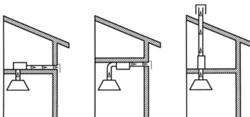
Исходя из выбранного типа установки, следует изменить положение впускного фланца воздуха с заглушкой.
