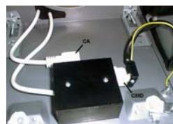
Положите крышку на коробку так, чтобы совместились соответствующие отверстия, и свинтите их прилагаемыми в комплекте винтами.
